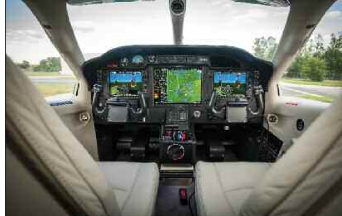
Zintegrowany glaskokpit Garmin 1000 tworzą dwa ekrany podstawowe (PFD) i jeden centralny wielofunkcyjny (MFD)
