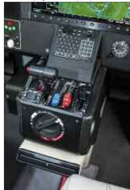
Przełącznik kłap w pozycji „850” odblokowuje ogranicznik mocy (torque limiter)
