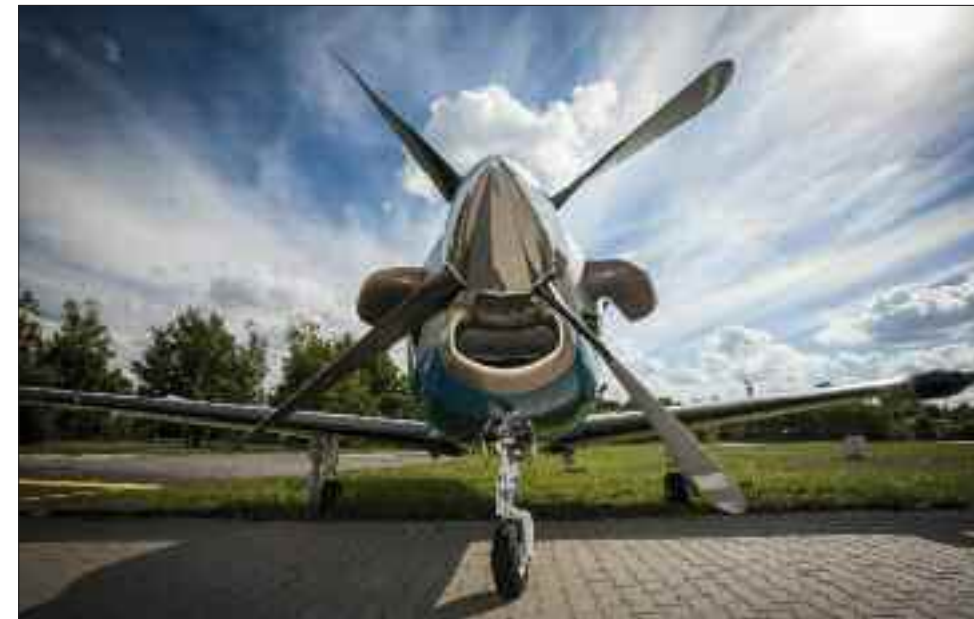
Wewnątrz chwytu powietrza widać separator chroniący silnik przed zassaniem ciał obcych z podłoża lub odłamków lodu w locie
