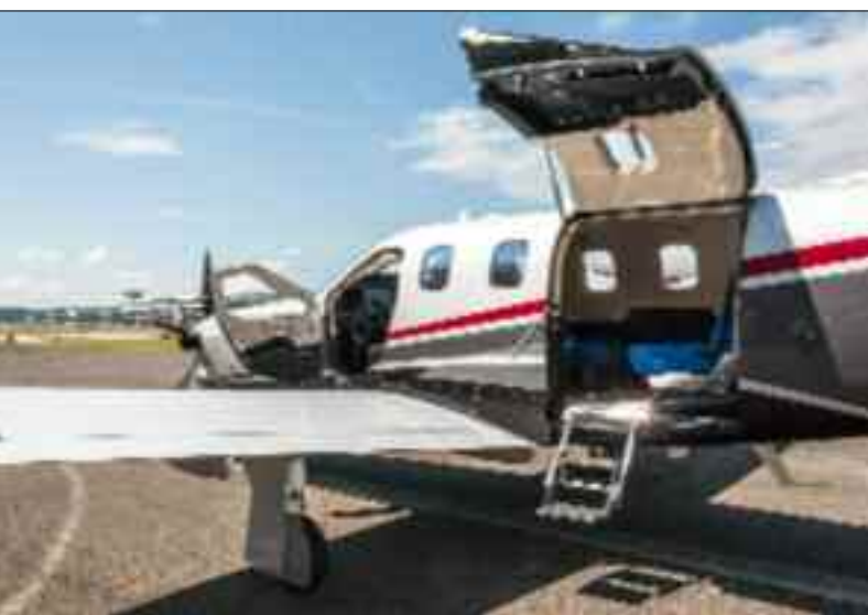
Niewątpliwą zaletą użytkową TBM-ki są szerokie drzwi kabiny pasażerskiej oraz oddzielne drzwi do kokpitu
