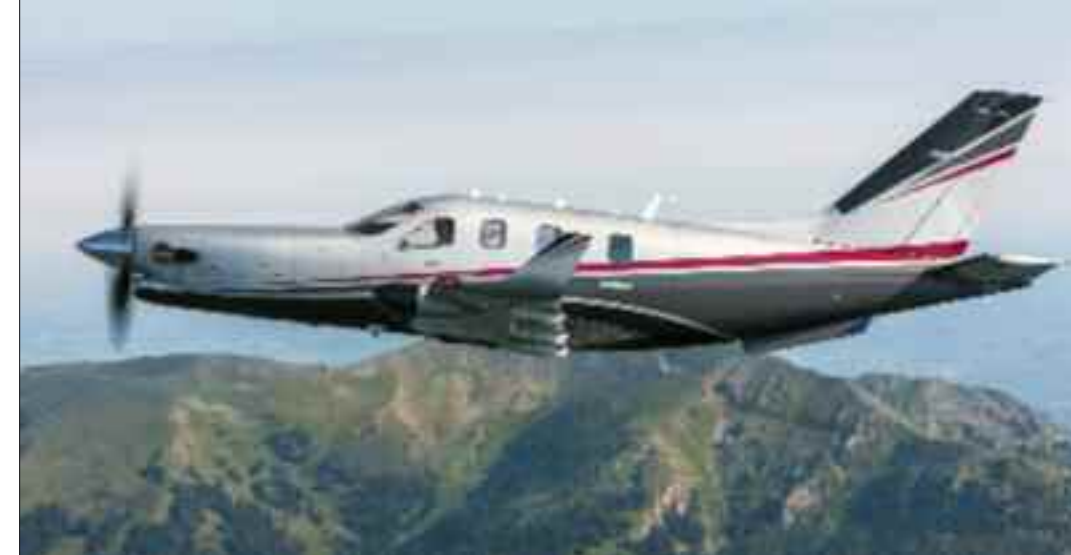
Cechą serii 900 są też nowe rozwiązania aerodynamiczne polepszające osiągi, min. winglety skrzydeł
