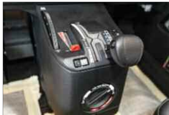
Cechą serii 900 jest pojedyncza dźwignia sterowania mocą
